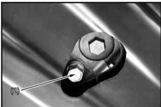
(2) Vite di drenaggio
