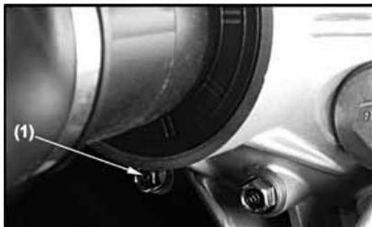
(1) Vite di drenaggio
