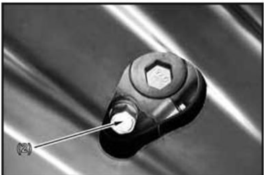
(2) Vite di drenaggio
