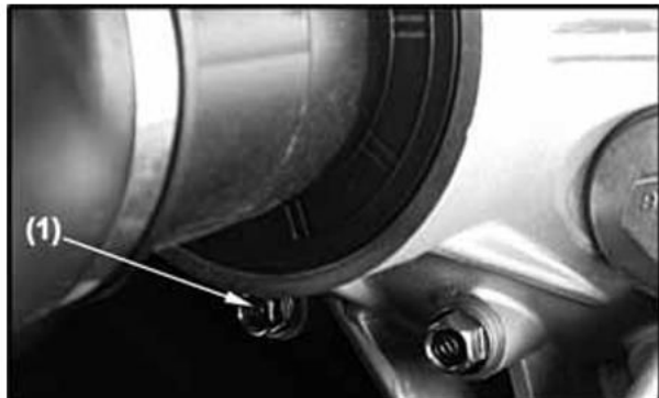
(1) Vite di drenaggio
